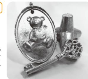
低い温度で溶ける金属を溶かして型枠に流し込みます。磨いてピカピカのメタルキーホルダーを製作します。
